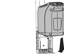
**2** Stecken Sie den Stecker in die Steckerbuchse an der Unterseite des Batteriehalters.
