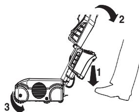
**4** Tenga cuidado de no bajar excesivamente el mango. Mantenga una distancia suficiente del suelo para que la batería no toque el suelo.
